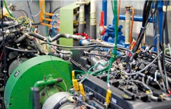
Mit zahlreichen Sensoren können die Motoren auf den Prüfständen präzise überwacht werden.
