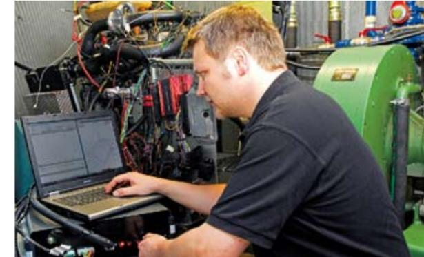
Mittels Laptop wird der Prüfzyklus für den Motor vorgegeben.
