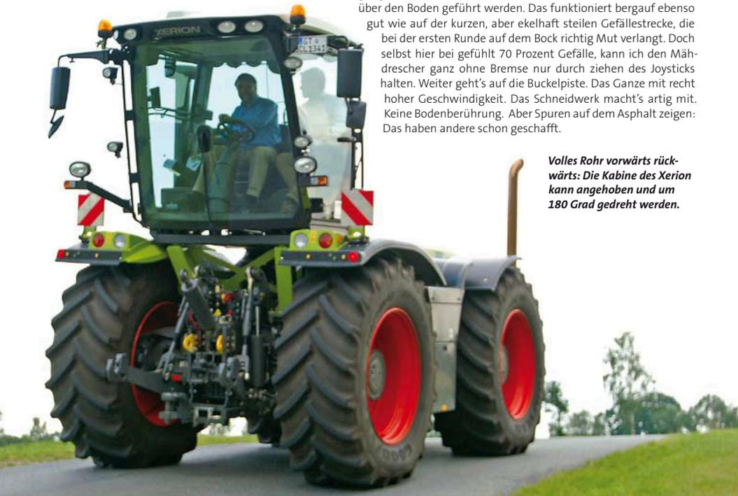
**Volles Rohr vorwärts rückwärts: Die Kabine des Xerion kann angehoben und um 180 Grad gedreht werden.**
