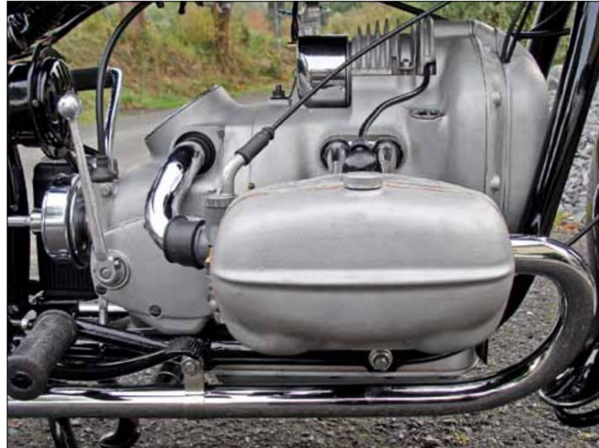
Der Zweizylinder-Boxermotor der BMW R5 hat einen Hub von 68 mm und ebenfalls eine Bohrung von 68 mm. Damit kommt er auf einen Hubraum von exakt 494 ccm.
